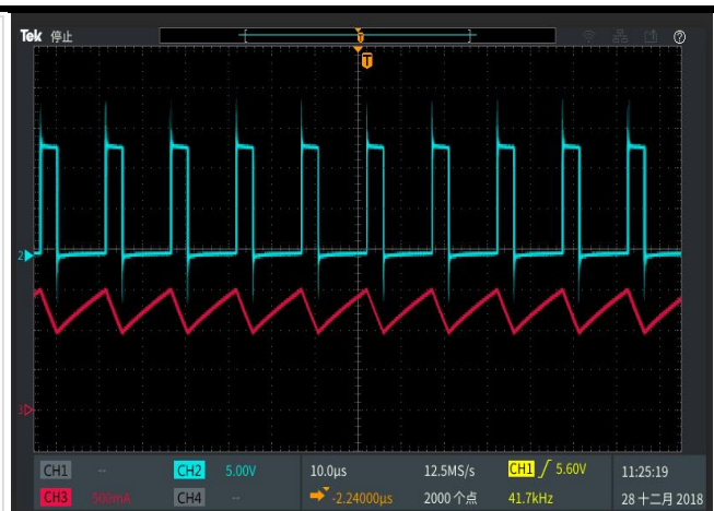
SW 脚与电感电流工作波形
